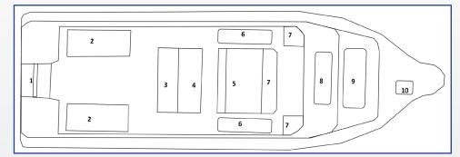
1 TRANSOM DOOR 2 FISH BOX 3 SEAT/STORAGE 4 LEANING POST 5 CONSOLE 6 STORAGE BOX 7 SEATS 8 WRAP- OROUND 9 STORAGE BOX 10 ANCHOR STORAGE
